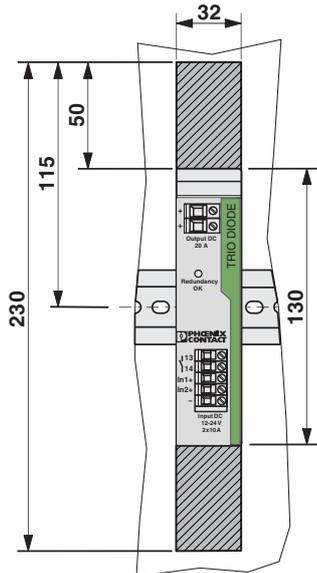
Einbaulage: Einbautiefe 115 mm (+ Tragschiene)
